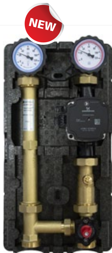
Nowa grupa pompowa AFRISO PrimoTherm 180-2 Vario DN25, pompa Grundfos UPM3 Hybrid, zawór mieszający ARV KvsVario
