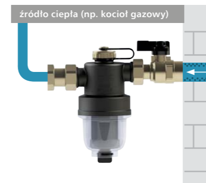
Montaż na przewodzie poziomym
