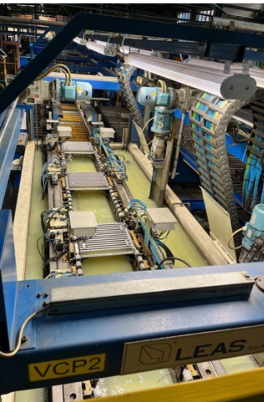
Sprawdzanie szczelności grzejników
