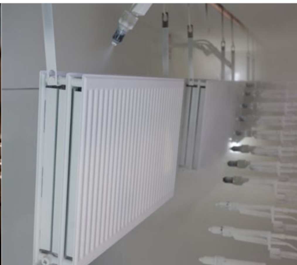
Zaledwie 18 min wystarczy, aby ze stali walcowanej powstał surowy grzejnik...
