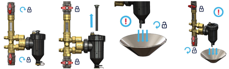
Rys. 16 Schemat konserwacji AHS 560
