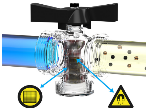
Rys. 1 Zasada działania zaworu kulowego BFV
