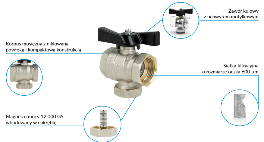
Rys. 2 Budowa zaworu kulowego BFV
