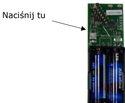
Rys. 2 Umieszczenie przycisku na płytce
