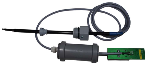
Rys. 3 Połączenie sondy z nadajnikiem
