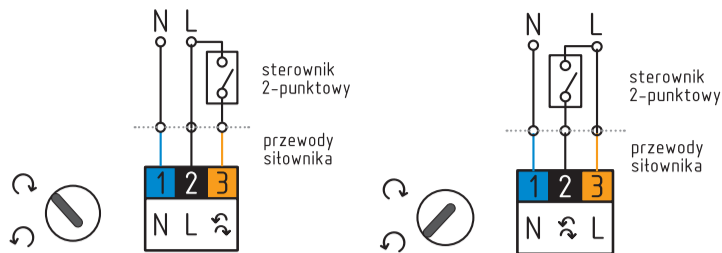
Rys. 10. Schemat elektryczny siłownika 2-punktowego, ustawienie w funkcji przełączania
