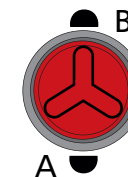
Rys. 2. Wskaźnik aktualnej pozycji zawieraadła na siłowniku
