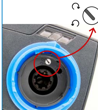
Abb. 8. Drehrichtungsschalter des Stellantriebs
