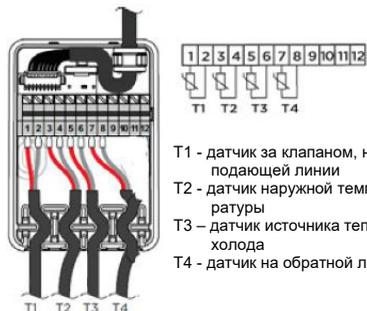
Рис. 12. Подключение привод-контроллера ARC 345
