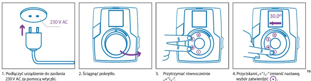
Рис. 11: Подключение PrimoBox ACB 930 к источнику питания и изменение значения температуры подачи в подающей линии
