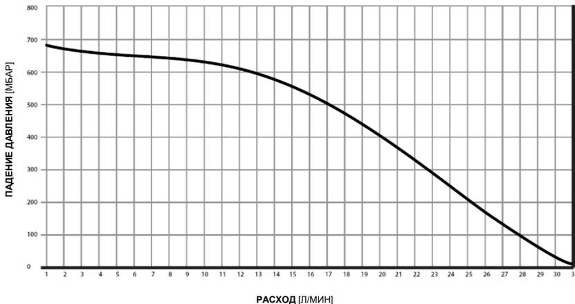
Рис. 6: Диаграмма расхода для контура со смесительным клапаном
