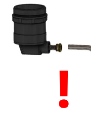
Rys. 12 Montaż śruby odpowietrznika
