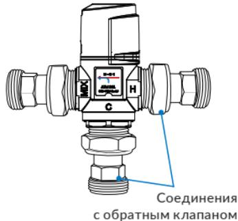
Рис. 1. Установка комплекта соединений на 3-ходовой смесительный клапан ATM
