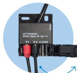
Rys. 6. Kostka przyłączeniowa czujników T1 i T2.
