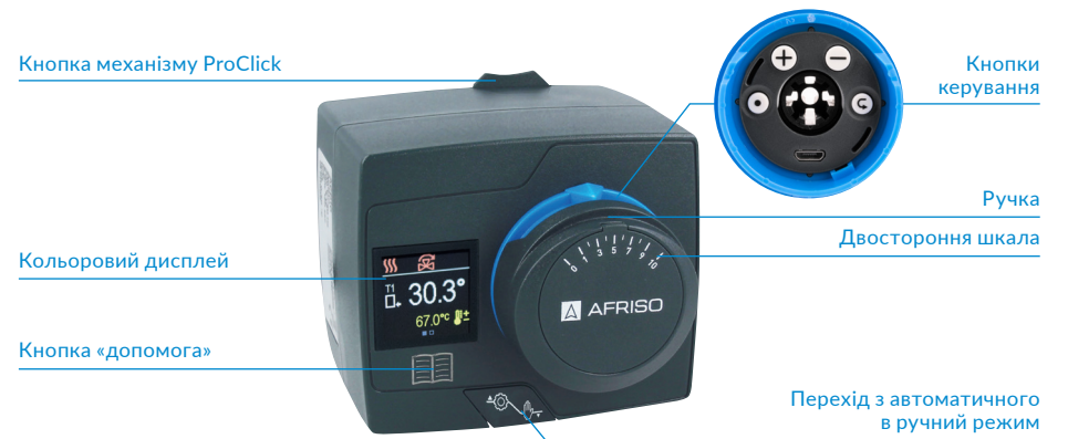
Рис. 1. Конструкція привід-контролера постійної температури ACT ProClick
