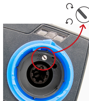
Рис. 14. Перемикач напрямку обертання приводу
