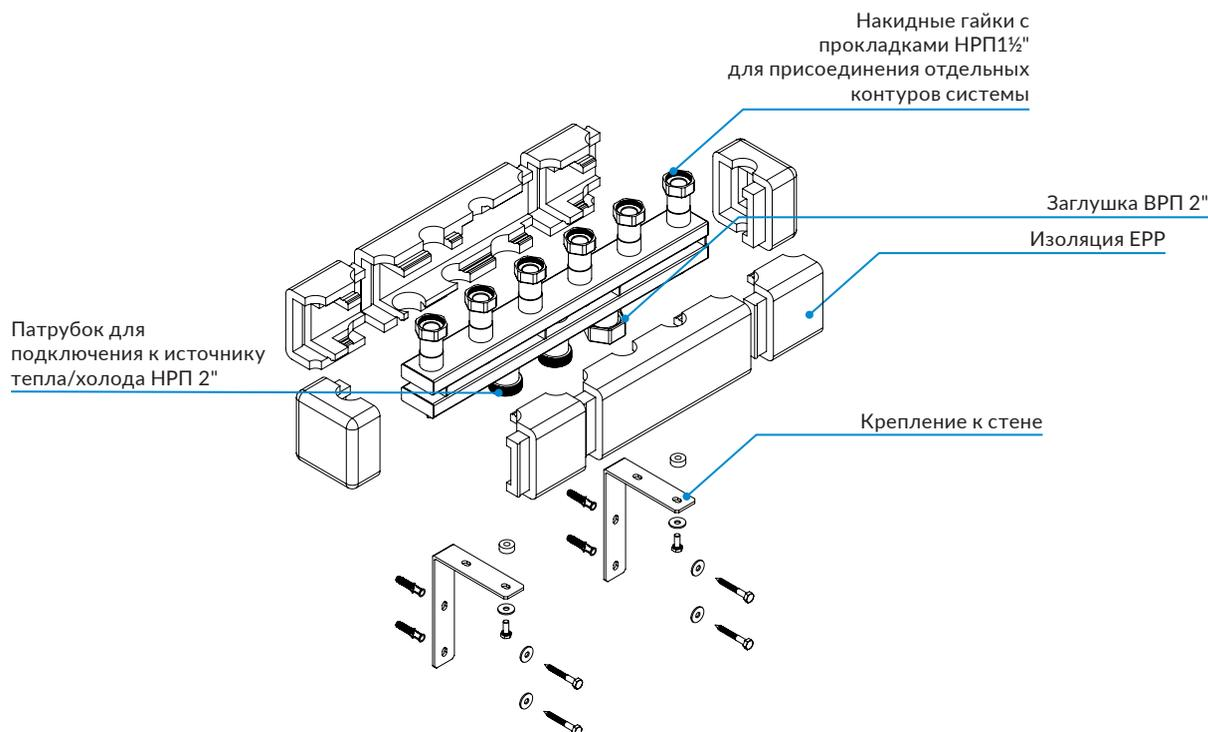
Распределительный коллектор KSV 125 - 160 кВт следует подключать к контурам отопления/охлаждения в соответствии с маркировкой на патрубках: **красный = подающая линия, синий = обратная линия из системы/к источнику тепла или холода**. Для подключения контуров отопления необходимо использовать прокладки из комплекта. Для герметизации соединений контура источника тепла/холода используйте прокладки или подходящий герметик, например, тефлоновую ленту.
