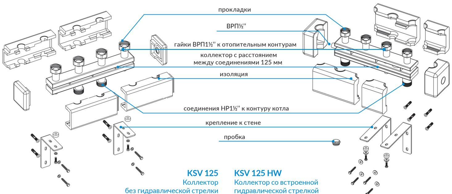
Коллекторы KSV 125 используются для распределения теплоносителя. Отопительные контуры подключаются к резьбе НРП $\frac{1}{2}$ " с помощью прокладок из комплекта. Соединение с контуром котла должно быть уплотнено точно таким же образом.
