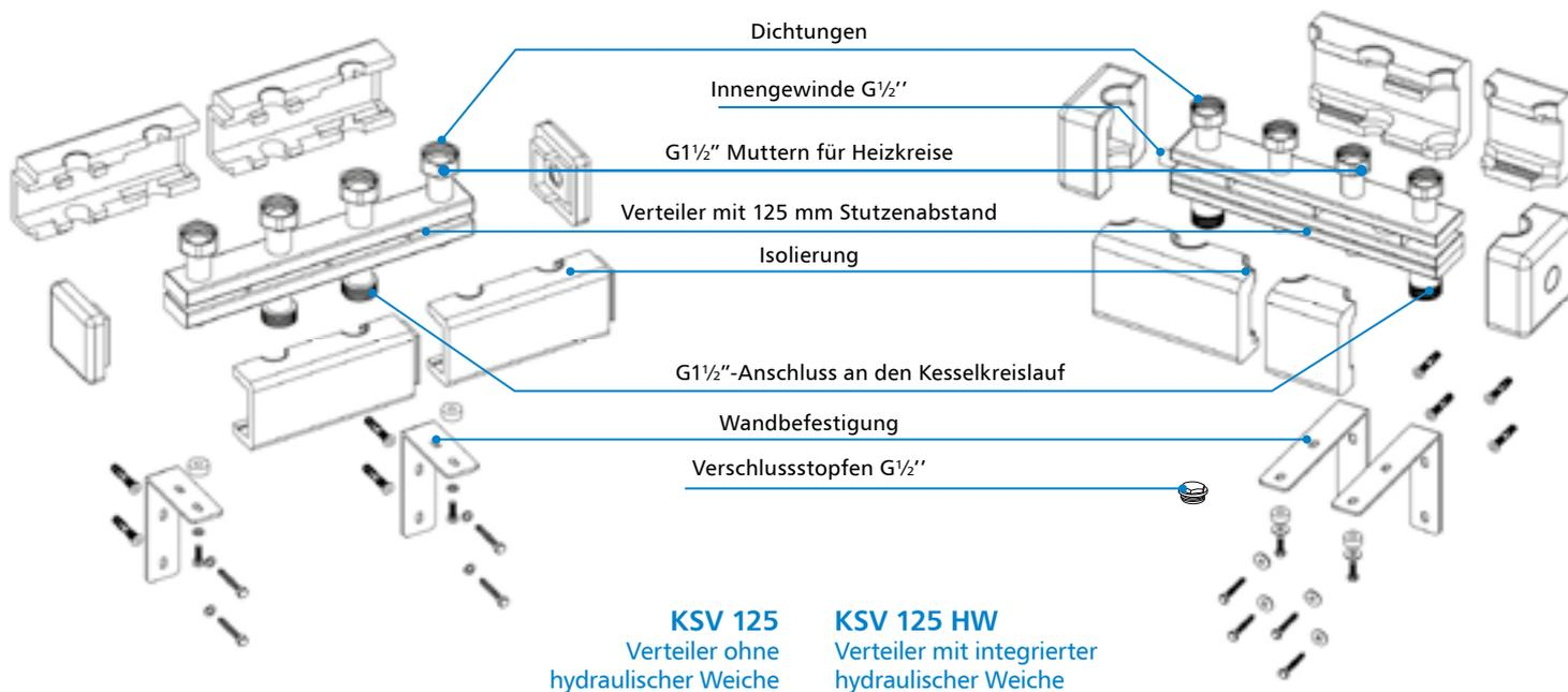
Die Verteiler KSV 125 dienen zur Verteilung des Heizmediums. Verbinden Sie die Heizkreise am Verteiler mit den (Gewinde G1½'') Flachdichtungen aus dem Set. Die Verbindung zum Kesselkreislauf muss auf die gleiche Weise erfolgen.
