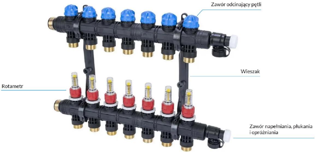
Rysunek 1: Budowa rozdzielacza ProCalida EF1 K
