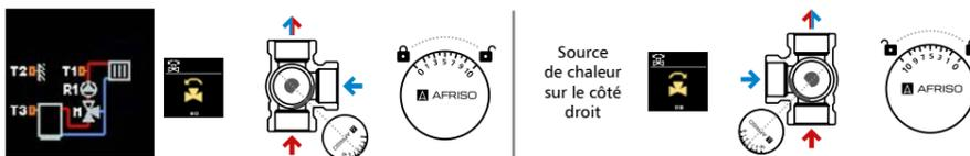
Fig. 9. Schéma avec la vanne mitigeur à 3 voies montée sur le tuyau d'alimentation (chauffage de surface ou par radiateur).
