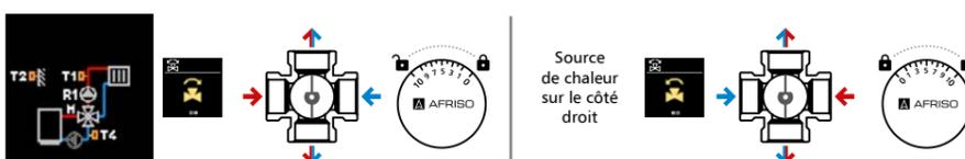
Fig. 11. Schéma avec la vanne mitigeur à 4 voies (chauffage de surface ou par radiateur) avec fonction de protection de la température de retour active.
