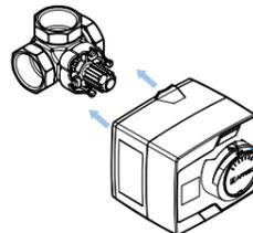
Fig. 4. Montage/démontage du régulateur.
