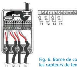
Fig. 6. Borne de connexion pour les capteurs de température.
