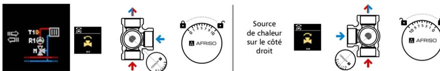
Fig. 10. Schéma avec la vanne mitigeur à 3 voies montée sur le tuyau d'alimentation (chauffage de surface ou par radiateur). Sélectionné pour connecter un autre régulateur en communication BUS.
