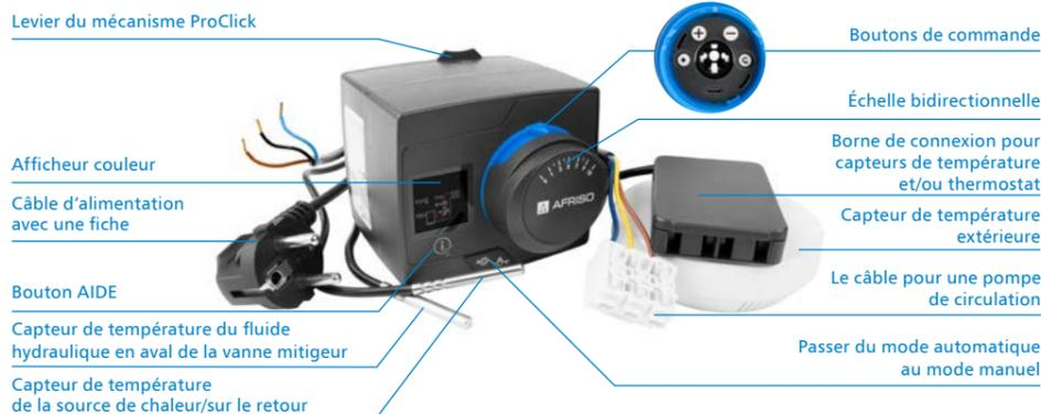
Fig 1. Construction du régulateur météo ARC 345 ProClick.
