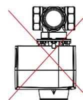
Fig. 3. Montage interdit.
