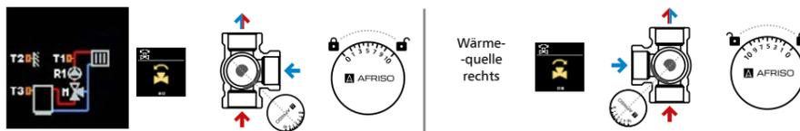
Abb. 9. Schema mit 3-Wege-Mischventil im Vorlauf (Flächen- oder Heizkörperheizung).
