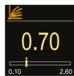
Wählen Sie die entsprechende Steigung der Heizkurve. Sie bestimmt den Wert der Vorlauftemperatur in der Anlage bei einer bestimmten Außentemperatur. Je größer die Steigung der Heizkurve ist, desto wärmer ist das Heizmedium. Die Werks-einstellung für die Heizkörperheizung ist 1, für die Flächenheizung ist sie 0,5. Die Parameter der Heizkurve können auch nach der Konfiguration des Reglers geändert werden (Parameter P2.1 und P2.2).
