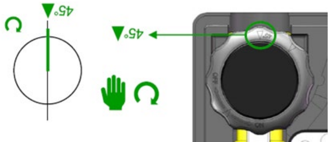
Рисунок 17: Положення кулі клапана під кутом 45°. У цьому положенні зворотний клапан постійно відкритий. Він не виконує свою функцію
