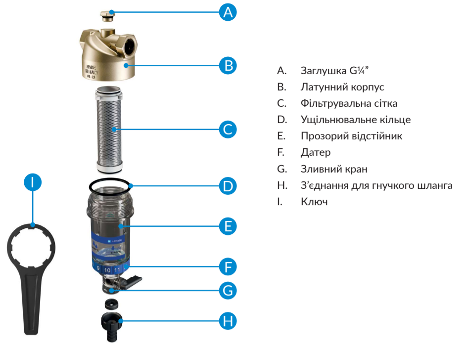
Рис. 2. Конструкція фільтра для води AWF
