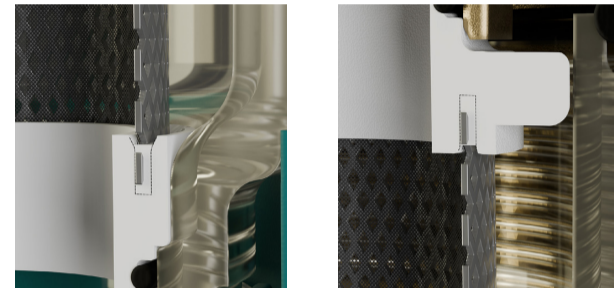
Рис. 3. Конструкція фільтрувальної сітки, завдяки якій забруднення не потрапляють у систему
