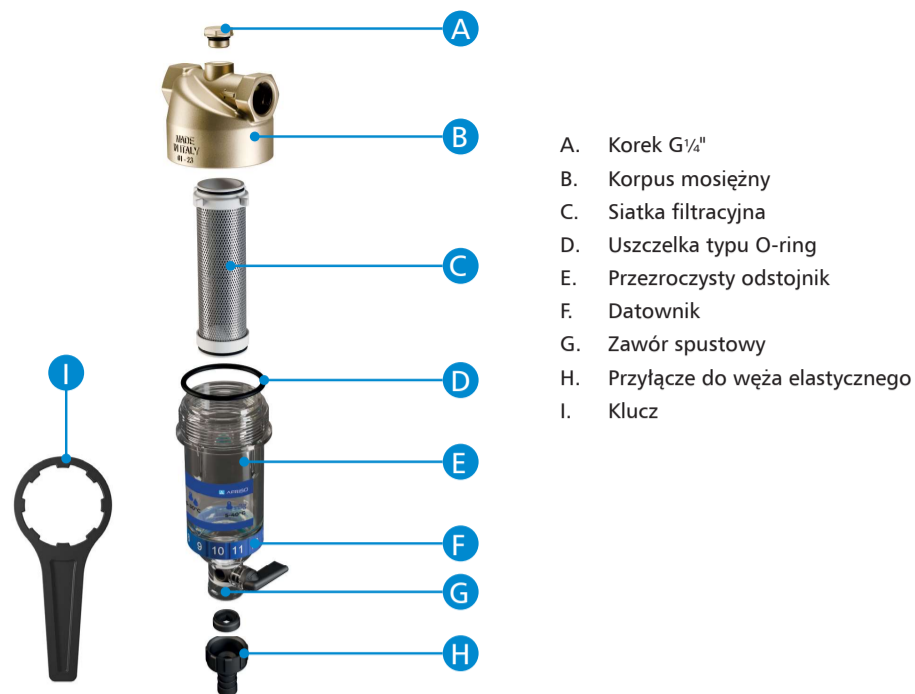
Rys. 2 Budowa filtra do wody AWF
