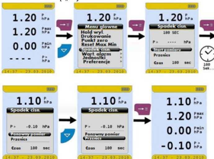
Rys.10. Pomiar spadku ciśnienia
