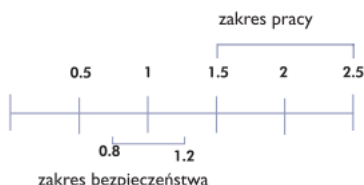
Rys. 2: Zakres pracy pompy
